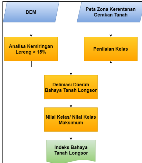
Gambar 16. Diagram Alir Pembuatan Peta Bahaya Tanah Longsor Berdasarkan Peta Zona Kerentanan Gerakan Tanah
